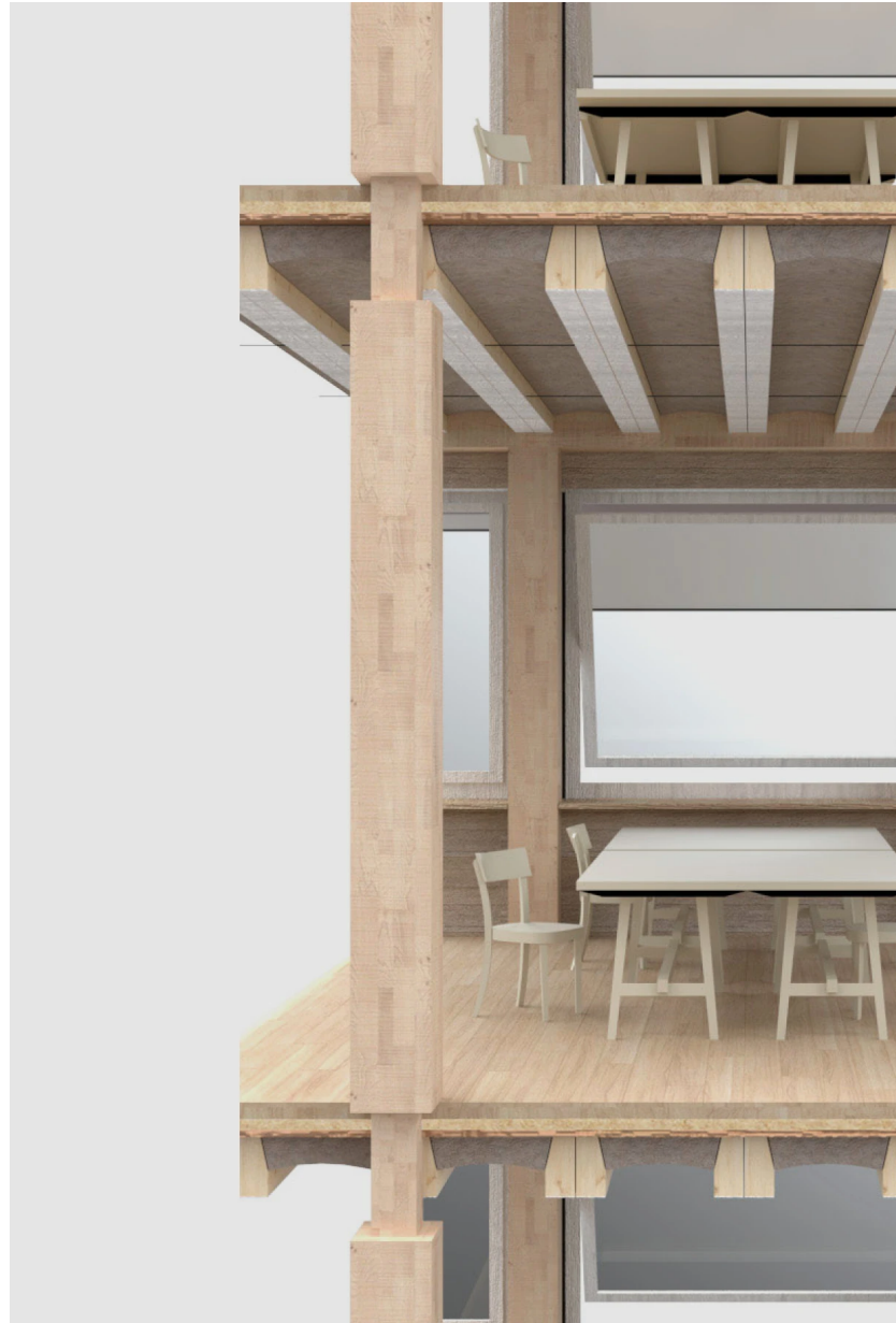
Hortus basiert auf einem Bausystem aus Buchenstützen und -trägern, Fichtenbalken und Lehmgewölbe
